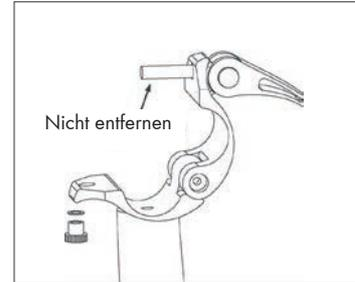
2. Öffnen Sie die Mutter und die Dichtung und klappen Sie den Mechanismus auf. Lassen Sie die Schraube dort.
